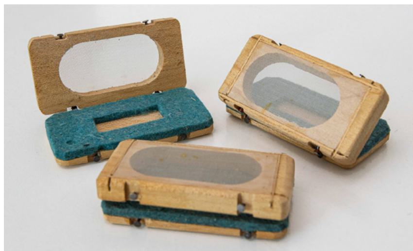
Imadeltka Weigla do podtrzymywania zakażonych wszy (u góry) oraz klatki do karmienia wszy (poniżej); z kolekcji pamiątek po prof. Kryńskim | fot. Paweł Sudara
