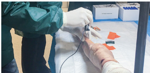
Prezentacja procesu mikroindentacji na modelu kości
